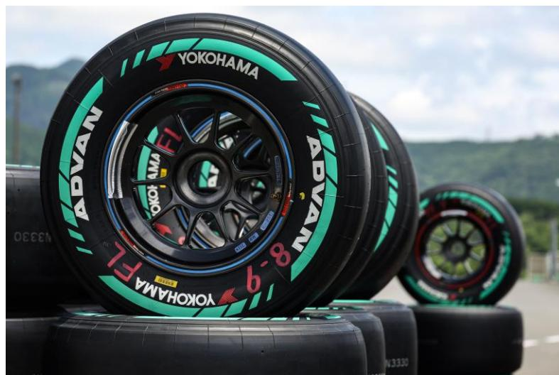
一般自動車とレーシングカーには様々な違いがありますが、一般タイヤとレーシングタイヤにも同じように様々な違いがあります。一般タイヤは私たちが通常自動車でいろいろなところに出かける際に必要な安全性や、乗り心地に関わってくる快適性、そして経済性を考慮して作られています。一方レーシングタイヤは、一般タイヤとは異なる速度域、異なる負荷がかけられる中で、速さを追求し限界時での操縦性と高い摩擦力（グリップ力）を優先して作られます。ときに時速300kmを超えるようなスピードで走行、強力なGにも耐えなければならないレーシングタイヤには高い剛性と強度が必要となるため、それに見合う構造を採用しているのです。
